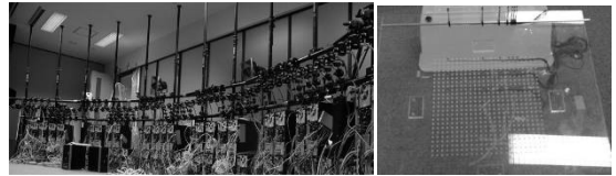
図1 カメラアレイとマイクロホンアレイ Fig.1 Camera and microphone array.
