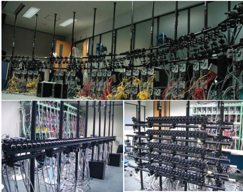
図 1.3 多視点映像音声撮影システム (上：円弧配置，左下：直線配置， 右下：2次元アレイ配置)
