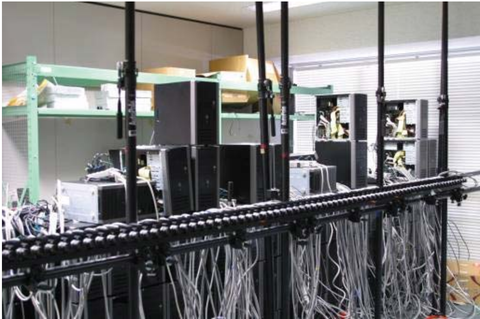
図 3.4 実際に用いた直線のカメラアレイ (80 台)
